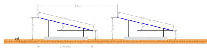
IMAGE D'UN EXEMPLE DE PLAN DE COUPE D'UNE CENTRALE SOLAIRE SUR GABION – SOURCE : MELVAN
